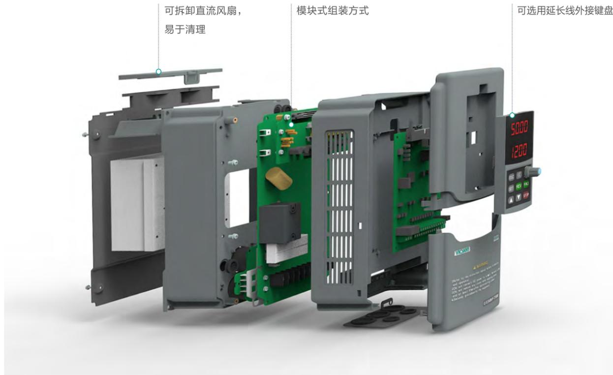
注：上图为VS500-4T0075机型分解图，由于产品大小不同，内部结构会有所变更，请以实物为准
