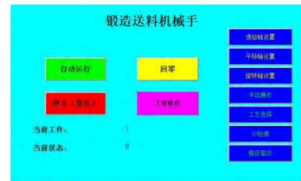
HMI工件库功能如图10所示，可以根据生产的不同工件的不同工艺设置相对应的参数，将此组参数保存下来，方便下次生产相同工件时直接调用。
