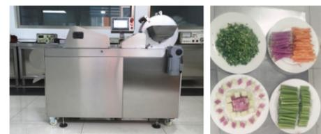
系统还具有自动换刀功能，通过HMI实现一键自动换刀，方便客户快速换刀，相比传统的换刀装置，极大地提升了换刀时间和便利性。在加工过程中和非加工过程中，采用了多重机械保护和电气保护，全面保证操作人员的人身安全。
