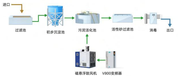
图1 市政污水处理工艺流程
