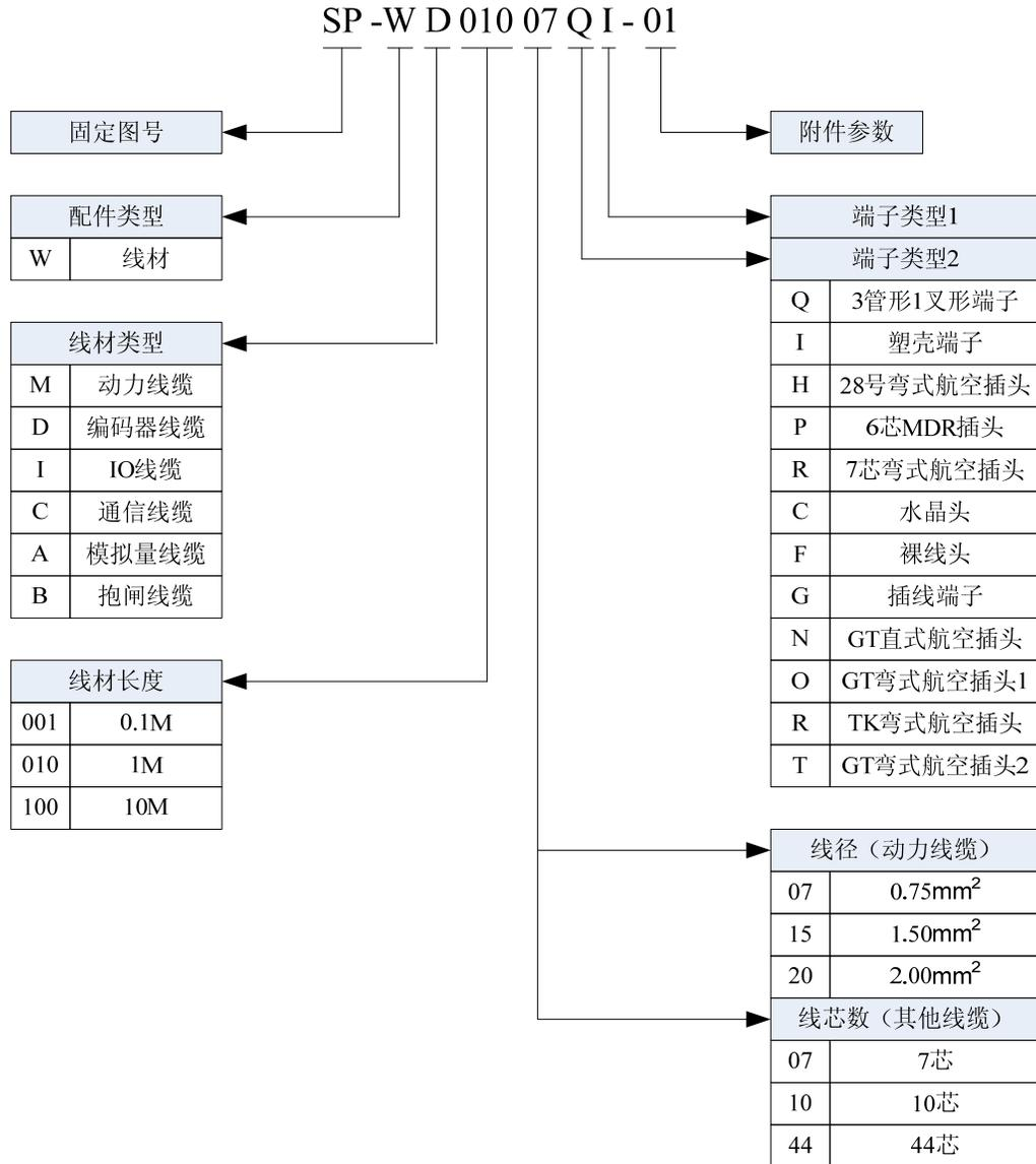
注：端子类型1为连接电机或其他上位装置的端子，端子类型2为连接伺服驱动器的端子。
