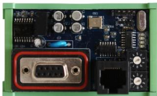
IOV-A111/A112 DP通信扩展卡是我司推出的与DX500 (1.5kW~4.0kW) 系列小功率变频器配套使用的可选配通信扩展卡。本卡分为主卡和副卡, 需要配合一起使用。本卡主要作用是将变频器作为DP智能从设备连接到PROFIBUS DP现场总线, 以实现现场总线控制系统 (FCS) 的主设备通过DP现场总线完成对变频器的快速访问控制。
