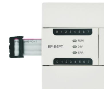
EP系列温度扩展模块, 配合EP系列PLC主模块使用。支持PT1000/PT100/CU50等多种热电阻输入, 能够测量-200~+600°C范围内的温度。产品精度高, 稳定性好, 抗干扰性强, 满足大部分工业环境使用需求。
