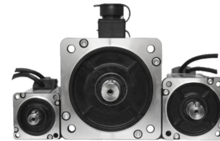
CM150 系列伺服电机是一种高性能永磁同步电机，过载能力强，启动转矩大，静态刚性好，抗负载扰动能力强；大、中、小惯量可供选，能较好的适应机械稳定性和高速响应性的需求。标配17bit单圈磁编绝对值编码器，电机可靠性高，寿命更长。
