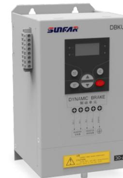
DBKU系列制动美观耐看, 增加键盘功能, 可方便的读取和设置各种参数; 硬件和软件功能重新设计, 增加了电流采样的功能, 具备有过流, 过载, 短路, IGBT直通等保护功能, 运行可靠稳定; 增加了电压跟踪制动, 制动过程更为平滑; 具备主从机功能, 方便多台制动单元并联使用。
