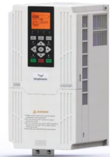
DX500系列是四方电气打造的新一代面向市场的高性能闭环矢量变频器，全面继承公司的高性能的矢量控制算法，具有优异的动态特性和强劲的过载能力，实现低转速大扭矩输出。此外，该系列产品标配永磁同步电机控制算法，集成简易伺服、分度定位等伺服功能，支持Modbus、CANopen、DP等多种通讯，可搭配扩展卡拓展各种丰富强大的功能，最高输出频率2000Hz，最大功率机型800kW，是一款性能优越、功能齐全的高性能矢量变频器，广泛应用于线缆、机床、金属切割、石油、化工、提升设备、纺织、印染、陶瓷等行业设备中，轻松面对各类复杂的工业现场。
